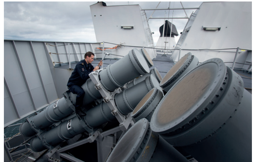
De Technische Dienst heeft de belangrijke taak de raketlanceerinrichtingen van schepen goed te onderhouden.
